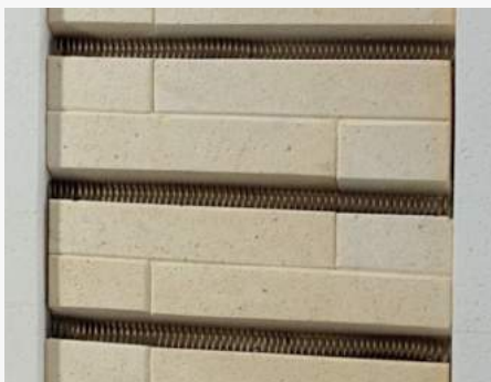
Topné elementy v drážkách cihel
