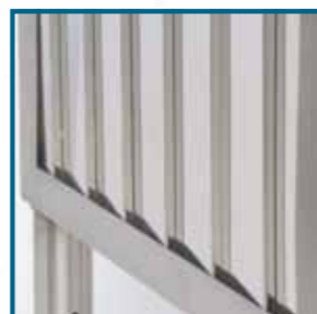
Extrémne nízka vonkajšia teplota díky lamelovým plechům se spodním odvětrávaním – žádné srážení kondenzované vody v izolaci
